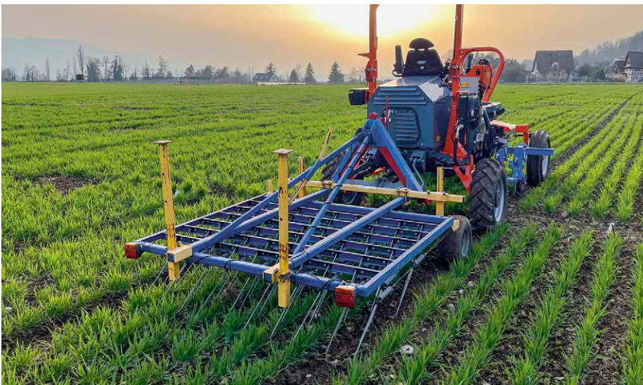
Der Geräteträger der gzpk mit Hackgerät vorne und gezogenem Striegel hinten.
